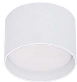
53006-9.5-001LD GX53 WT алюминий D=83mm h=55mm цоколь лампы: GX53
